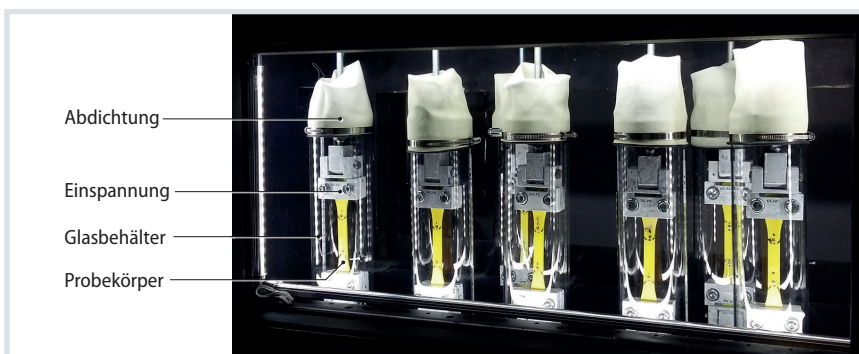
Bild 6. Prüfstand mit eingespannten Probekörpern, die mit Meerwasser gefüllt sind. Die Prüfplätze befinden sich in einer Temperierkammer, die eine konstante Temperatur garantiert. Quelle: IKV; Grafik: © Hanser
